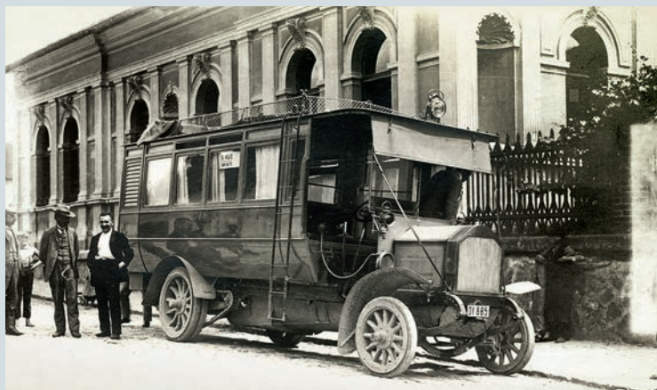
Poštovní úřad v domě čp. 10 s poštovním autobusem L&K HOS po roce 1908
